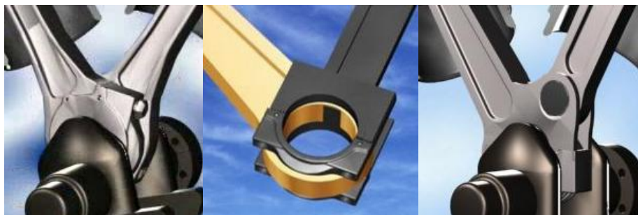
30图 4-23V 型柴油机连杆示意图
